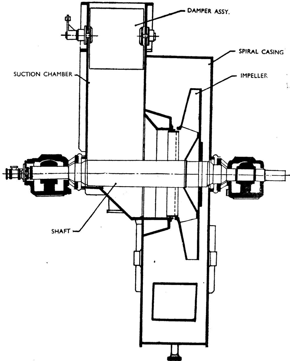
FIG. -4 SINGLE SUCTION RADIAL FAN(NDV)
